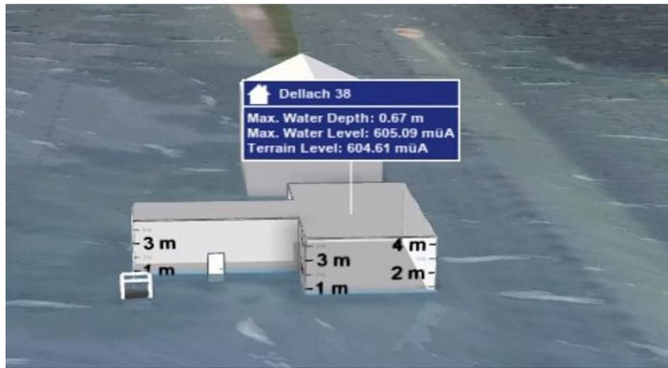
Abbildung: Darstellung BF Dellach im Drautal mit Wasserspiegellagen
